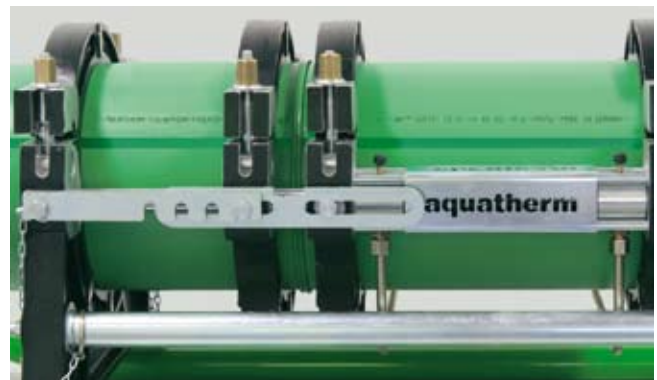
трубы свести, под давлением дать остыть
