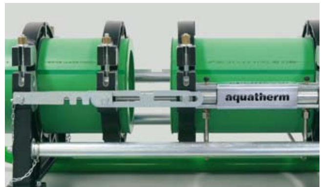
трубы развести, убрать нагревательный элемент
