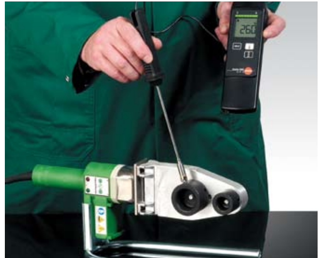
контроль температуры прибором для быстрого измерения температуры поверхности
