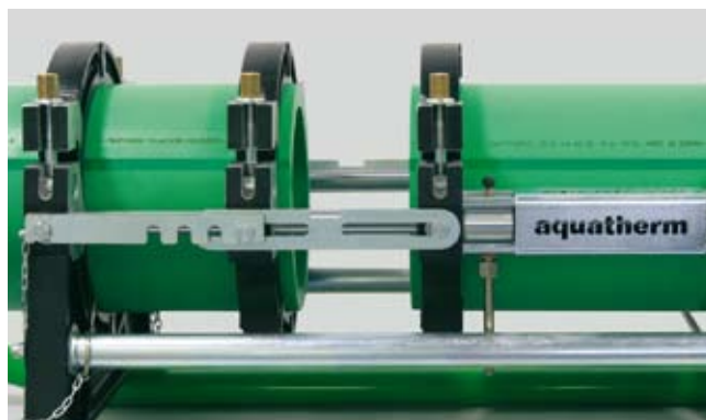
свариваемые части вставить, выровнять и зафиксировать вставить рубанок-заготовитель
